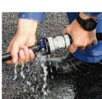
『ストップリング』により 水圧による管離脱を防止
