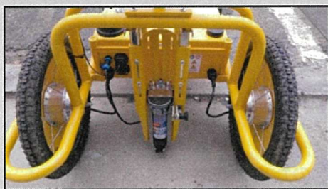
スプレー缶設置状況
